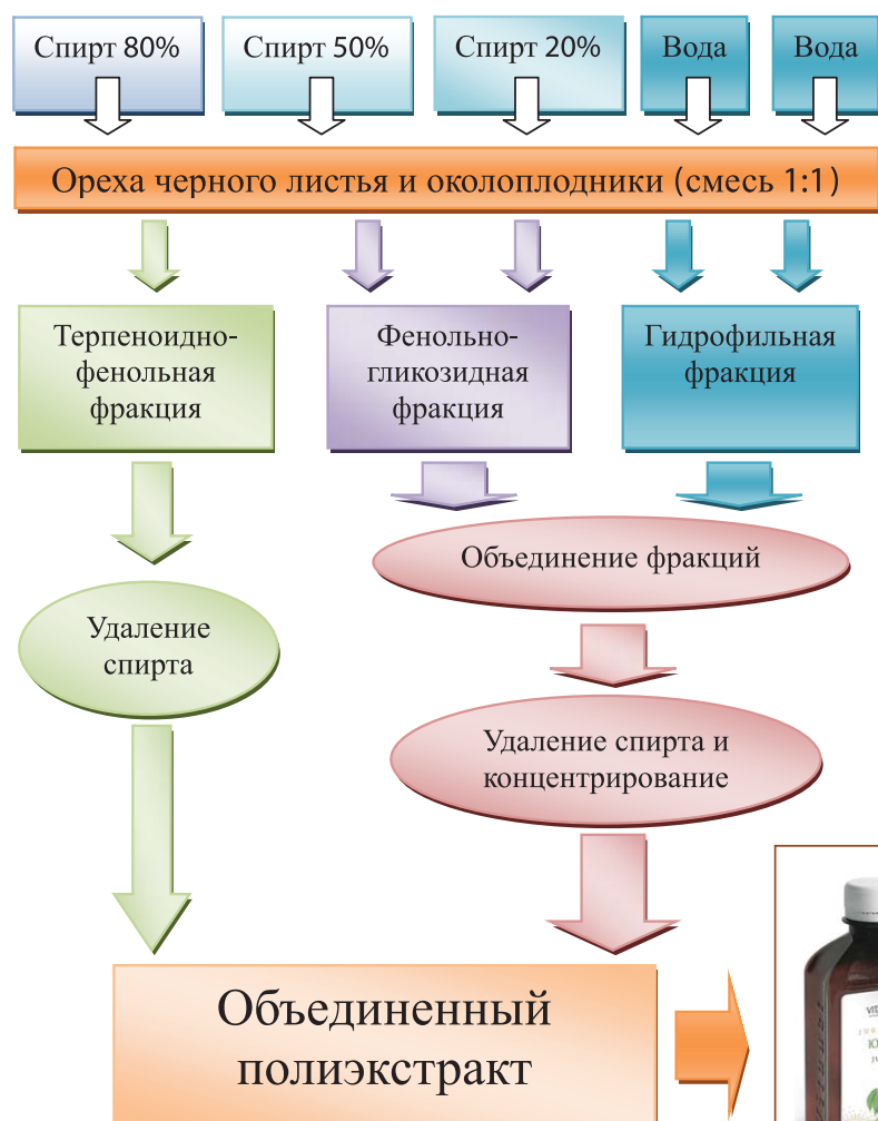
Рисунок 2. Схема комплексной промышленной переработки сырья ореха черного в технологии БАД «ЮГЛОН»
